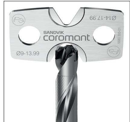
**5** Die patentierte Schnittstelle ermöglicht einen schnellen und einfachen Wechsel des Kopfes ohne Ersatzteile © Sandvik Coromant
